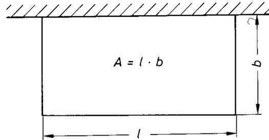
6. Aus Blechtafeln  $500 \text{ mm} \times 800 \text{ mm}$  sollen durch Ausschneiden, Biegen und Schweißen nach Skizze allseitig geschlossene quaderförmige Kanister mit möglichst großem Volumen hergestellt werden. Es sind Maße und Volumen des Quaders zu berechnen.
