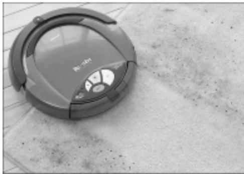
Operada por baterías capaces de permitirle hora y media de trabajo (para unos tres cuartos medianos), «Roomba» tiene la forma de un platillo volador, unos 30 centímetros de diámetro por 10 de alto.
