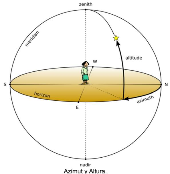
**H - La altura** es el arco de vertical del astro contado desde el horizonte verdadero hasta el astro. Toma valores de  $0^\circ$  a  $90^\circ$  con signo positivo. Cuando se mide utilizando un sextante o un teodolito se obtiene una altura topocéntrica que debe corregirse para obtener la geocéntrica correspondiente.
