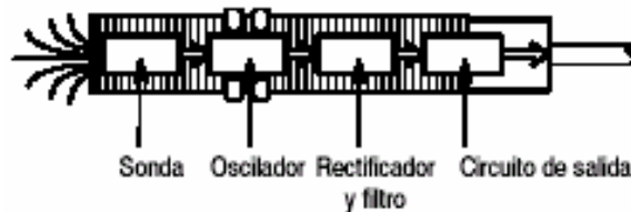
Figura 3.7: Componentes de un sensor de proximidad capacitivo.
