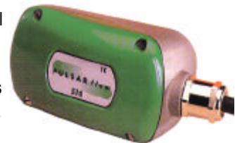
Este instrumento se coloca pegado a la pared exterior de un deposito metálico y mide la reflexión de las ondas sonoras, estas varían si existe liquido en el punto de colocación o no.
