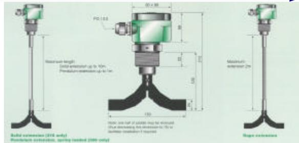
Este aparato dispone de una paleta que gira movida por un motor, al entrar en contacto con un sólido, su giro se detiene y nos da un contacto de salida.
