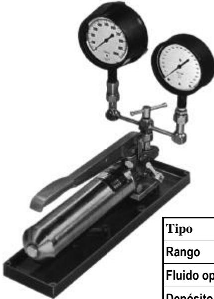
Los modelos T y R llevan una bomba con doble volumen, proporciona un alto volumen a baja presión para llenar rápidamente el circuito, al cambiar el modo proporciona bajo volumen a alta presión para aproximarse gradualmente al punto de prueba con poco esfuerzo. Llevan también un tornillo para ajuste fino y válvula de descarga.
