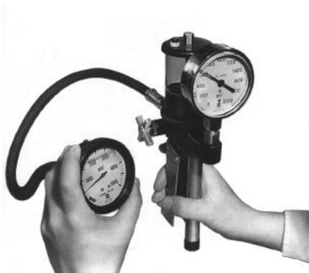
Bomba hidráulica hasta 345 Bar
