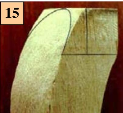
Inicie o desbaste pelas arestas usando o **Formão**, indo ao encontro da linha do **Joelho** (**Figura16-a**). Use as costas do **Formão** (**Figura16**) para que o contorno do **Joelho** fique perpendicular ao seu risco.
