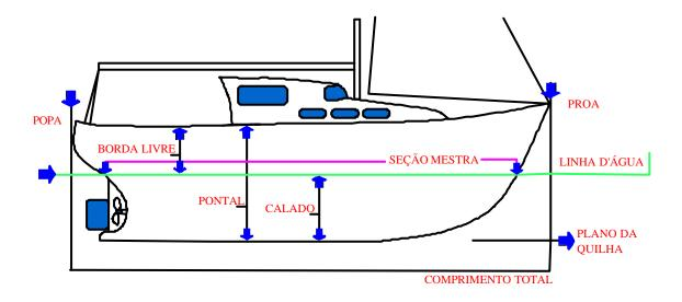
Dimensões Lineares: As principais dimensões de uma embarcação são:
