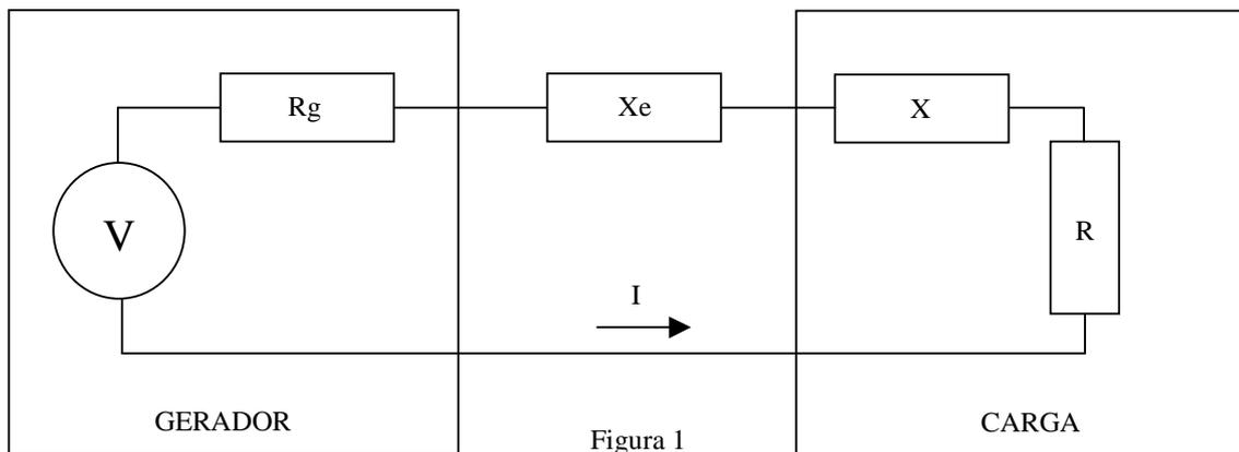
Um gerador de tensão  $V$  e resistência interna  $R_g$  (supomos, como é usual acontecer, o gerador sem reatância própria; isto não altera a generalidade da demonstração) é acoplado a uma carga de componente resistiva  $R$  e reativa  $X$ , através de uma reatância externa auxiliar  $X_e$ .
