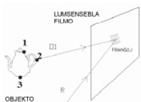
Bildo 6. Rezulto de eta objekta fasko interfere al referenca fasko: franĝoj kies direkto kaj distanco rilatas al la du anguloj de la objekta radio refere al tiu de la referenca radio. La distanco inter franĝoj (tipe 1 \mu\text{m} , po mil franĝoj milimetre) egalas la longecon de ondo (tipe 650 nm) dividite de la adicio de la sinuso de la anguloj.
