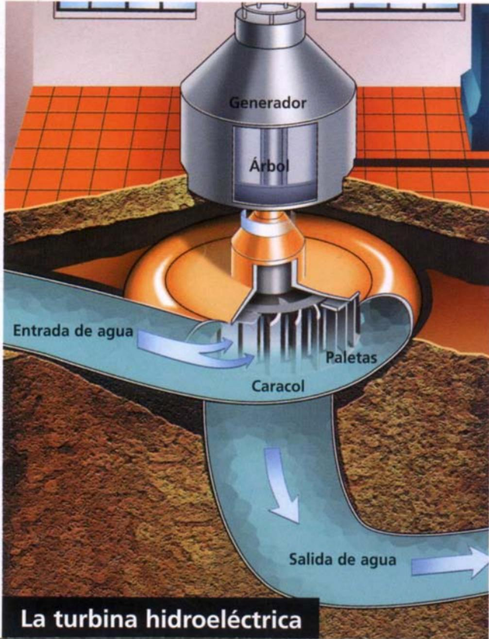
**La turbina hidroeléctrica**
