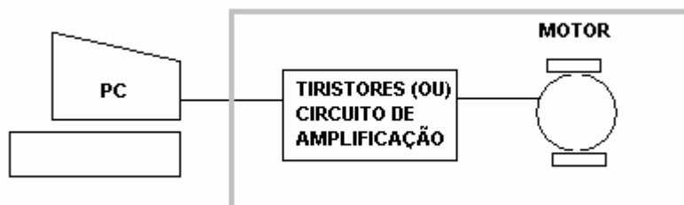
Fig 5- Acionando um motor através da serial
